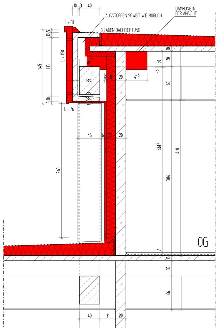
F4.2 - FASSADENSCHNITT OSTSEITE (ANSCHLUSS ALUCOBOND)
