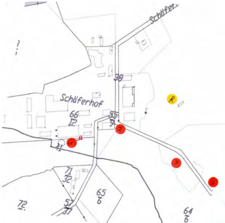
Abbildung 7: Löschwasserentnahmestellen, ohne Maßstab
