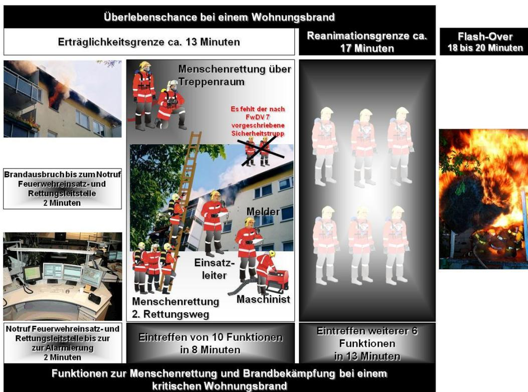
Der Umfang der Einsatzleitung ist nach der Feuerwehrdienstvorschrift FwDV 100 abhängig von der Gefahrenlage, dem Schadenereignis und den zu führenden Einheiten. Bei den alltäglichen Einsätzen zur Gefahrenabwehr kann die Einsatzleiterin oder der Einsatzleiter (zum Beispiel die Gruppenführerin oder der Gruppenführer) in der Regel ohne Unterstützung durch weitere Führungskräfte und weiteres Führungsunterstützungspersonal die anstehenden Aufgaben erfüllen.
