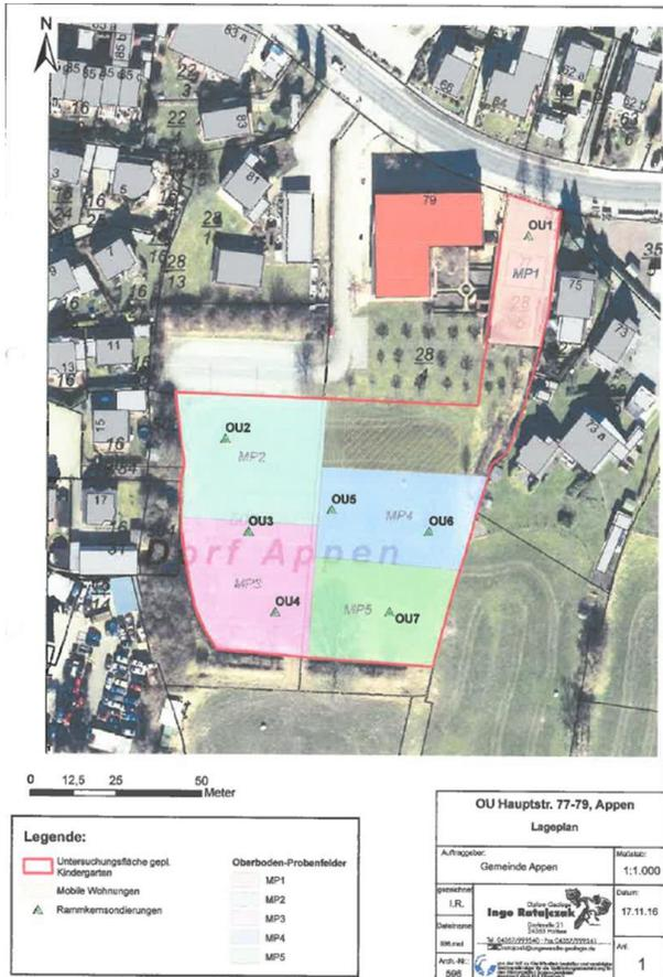
Lageplan der Baugrundsondierungspunkte und der Mischprobenfläche aus orientierender Erkundung Ratajczak
