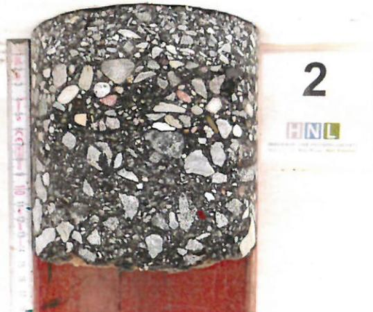
Bild 4: Mantelfläche Bohrkern Nr. 2
