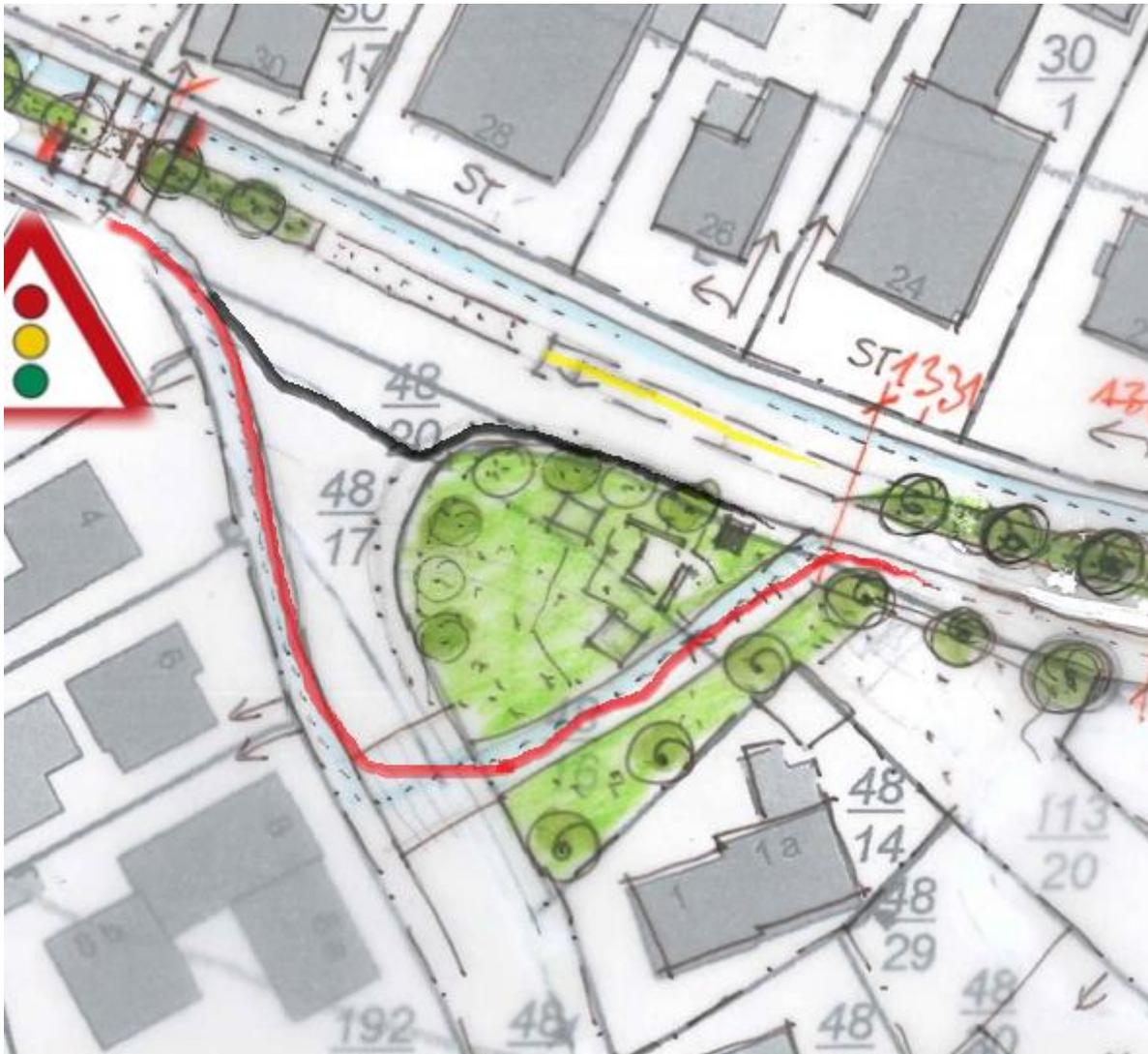
Der Fuß- und Radweg würde hinter das Denkmal verlegt werden (rote Linie). Die Straßenquerung K13 würde somit in Richtung Dana- Pflegeheim verlegt werden. Durch die Verlegung kommt es zu einer Entzerrung im Kreuzungsbereich. Rad- und Fußgänger würden die Straße in einem besser einseharen Bereich queren. Die Begegnung mit PKW/LKW findet somit nicht mehr im Kreuzungsbereich statt.
