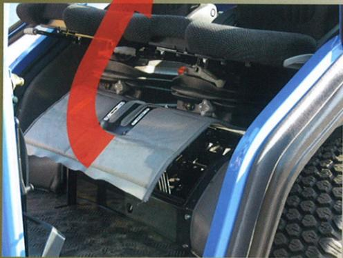
Oft werden Kommunaltraktoren im Arbeitseinsatz stark verunreinigt. Besonders im Winterdienst dringt Salz in die Maschine und kann zu Funktionsstörungen führen. Einmalig in diesem Segment kann bei beiden Ergo-Kabinen der Boden angehoben werden, um Reinigungs- oder Wartungsarbeiten durchzuführen.
