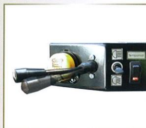
Im linken Panell wird mit dem gelben Sicherheitsschalter die Zapfwelle zugeschaltet. Der Steuerhebel regelt die Funktionen Tempomat, Blinker und Hupe.
