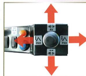
Im rechten Panell wird die gesamte Hydraulikanlage (Front + Heck) gesteuert. Zum Verstellen der Frontgeräte muss die Hand das Lenkrad nicht verlassen.
