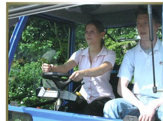
Mit dem seitlich versetztem Lenkrad der Ergo 2 Kabine wird jedem Mitfahrer eine bequeme Sitzposition ermöglicht. Im Heckbereich der Kabine steht Ihnen ein umfangreicher Stauraum für persönliche Gegenstände zur Verfügung. Selbstverständlich ist bei beiden Kabinen im Heck eine Steckdose für Kühlbox, Radio, Funk u.s.w. vorhanden.
