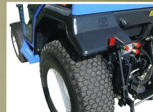
Nichtrostende Kotflügel decken die Hinterräder optimal ab. Spritzwasser kann bei dieser Version die Scheiben nicht verunreinigen.
