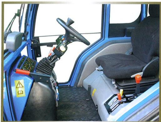
Der sehr große Fußraum bietet Ihnen viel Platz für eine entspannte und ungezwungene Fuß- und Beinsetzung. Alle Bedienelemente sind farblich markiert (rote Hebel = Antrieb / Motor) oder (gelbe Hebel = Zapfwellschaltung).
