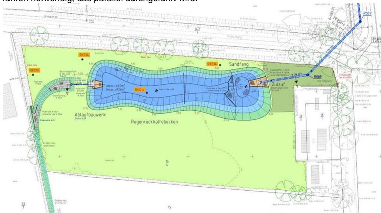
Abb. 7: Entwurf des Regenrückhaltebeckens südwestlich des Plangebietes, ohne Maßstab
