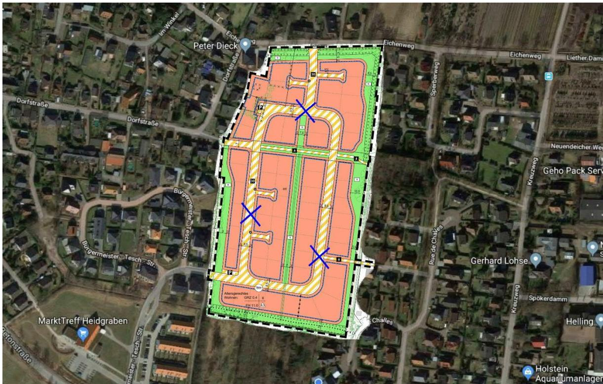
Abbildung 11 - Lageplan mit Kennzeichnung der zusätzlich geplanten Hydranten
