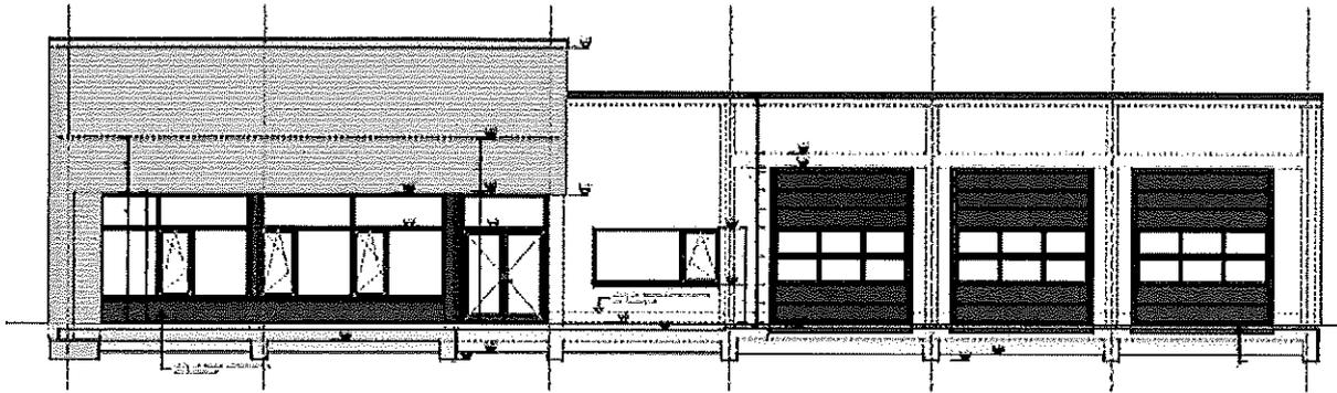
Die Dachaufbaufläche A des Anbaus der Feuerwache in Hetlingen hat eine Neigung von ca. 15 Grad, ist in Richtung Süden ausgerichtet, hat eine Breite von ca. 13,50 m und eine Höhe von ca. 7,50 m. (längsschraffierte Fläche des Dachbereiches)
