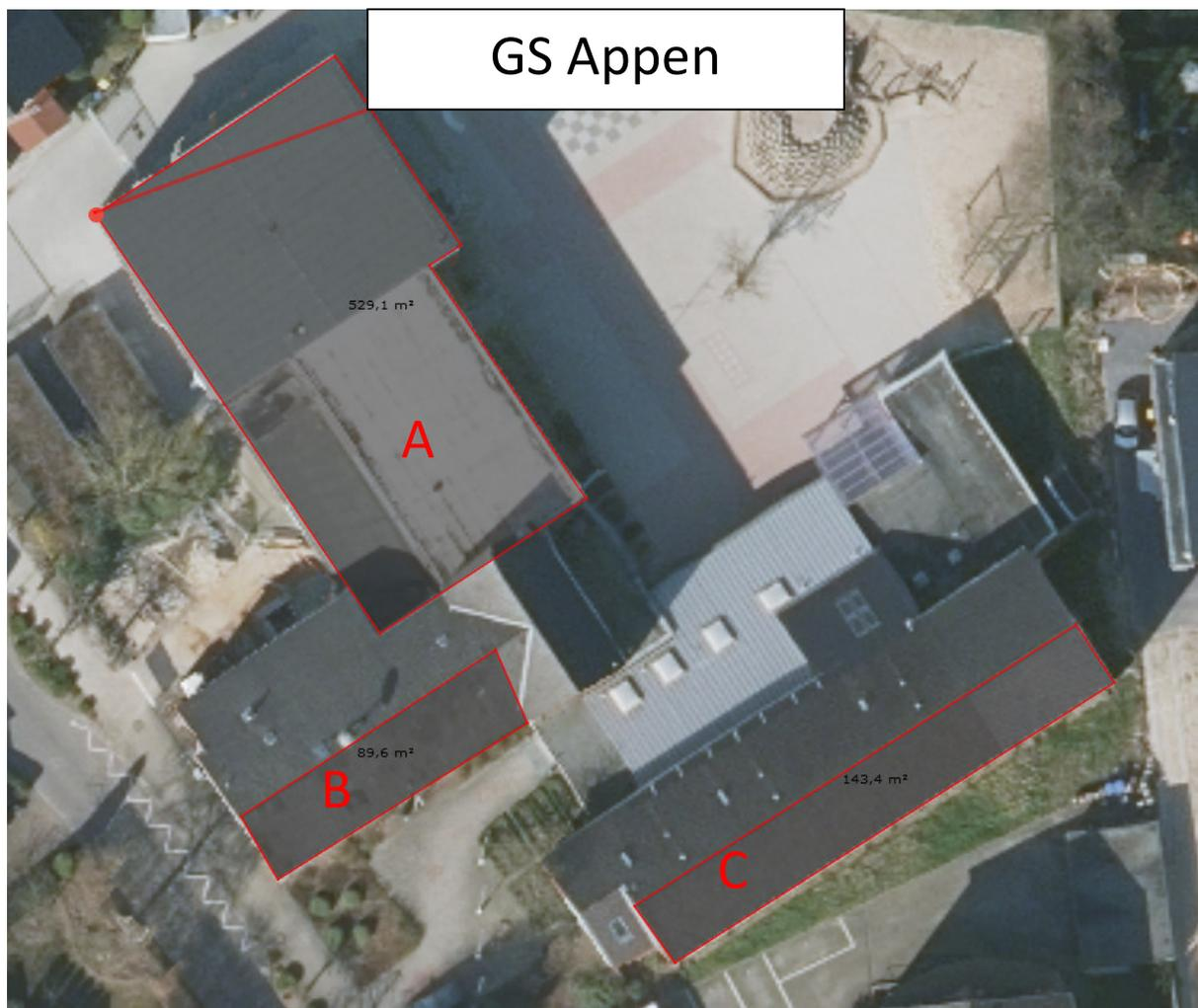
Die Herstellung einer 30 kWp PV-Anlage wäre auf den Dächern B und C am besten, jedoch könnte der Platzbedarf nicht ausreichend sein, wodurch die Kosten des Montagesystems beim Ausweichen auf das Dach A ansteigen würden.
