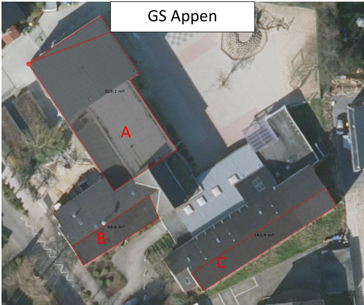
Die Herstellung einer 30 kWp PV-Anlage wäre auf den Dächern B und C am besten, jedoch könnte der Platzbedarf nicht ausreichend sein, wodurch die Kosten des Montagesystems beim Ausweichen auf das Dach A ansteigen würden.
