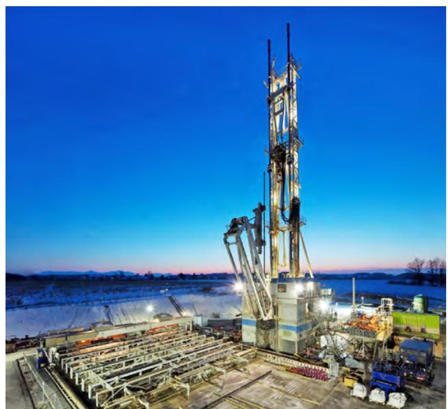
Die hydraulischen Tests sind der erste wesentliche Schritt bei einem Geothermieprojekt, bei dem man erkennt, ob die vorhergesagte Förderrate und Fördertemperatur über einen bestimmten Zeitraum realisiert werden kann. Somit dienen sie als Merkmal für die Performance der Bohrung am Standort. Dabei unterscheidet man zwischen Förder- und Injektionstests.
