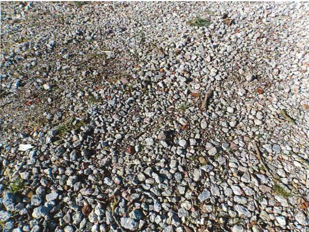
Foto 3: Detail des aufgebrachtten Recyclingmaterials aus dem Abbruch des ehem. Durckereigebäudes
