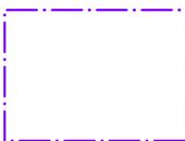
Abgrenzung der Fläche, in dem das Niederschlagswasser bei Neu- und Umbau bei zusätzlichen Versiegelungen zu versickern ist. (§ 9 Abs. 1 Nr. 16 BauGB, Text 4.1)
