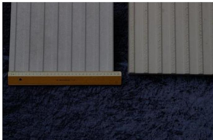
**Bild 20: Bodenindikatoren mit 40 mm Rippenabstand**
