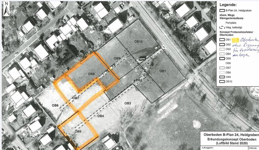
Bereiche in den der Oberboden nicht für die Herstellung der durchwurzelbaren/ belebten Bodenschicht einer Versickerungsmulde geeignet ist. Darstellung uBB vom 09.06.2023.
