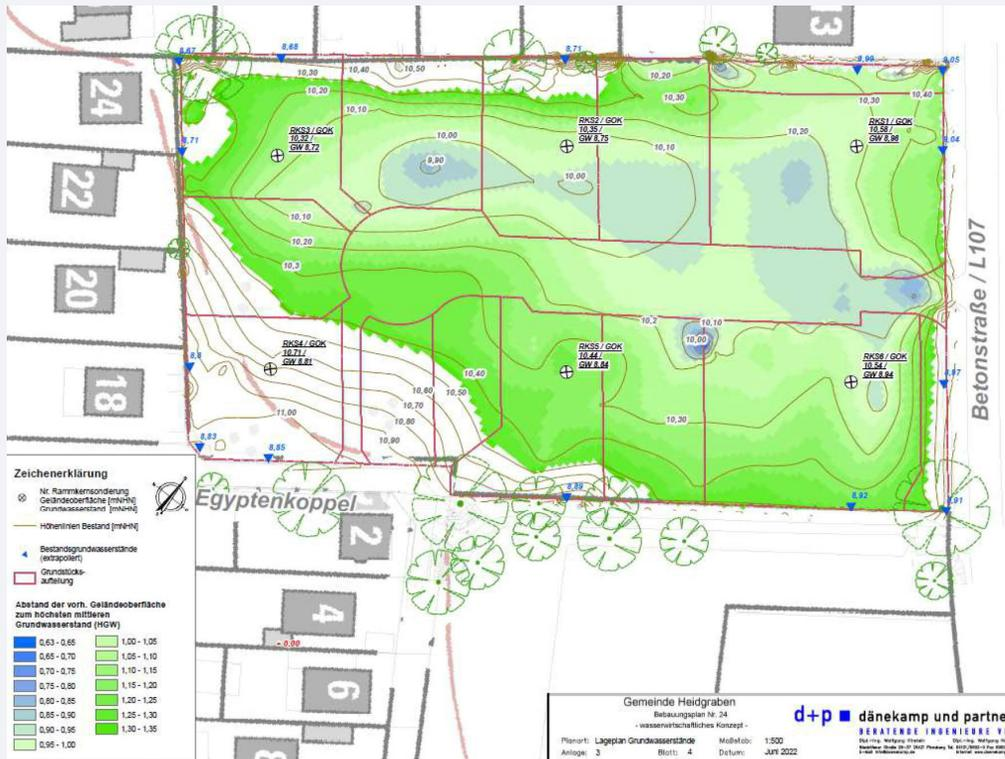
Abb. 1: Anlage 3 des wasserwirtschaftlichen Konzeptes, mit den derzeitigen Abstände der IST-Geländehöhe 2022 zum höchstmöglichen mittleren Grundwasserabstand.
