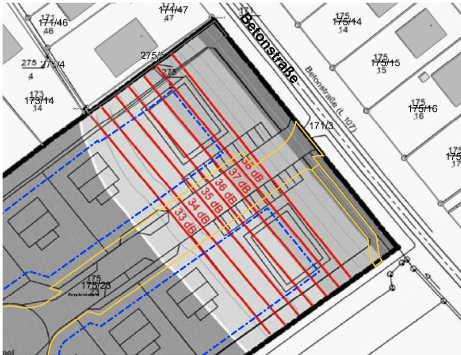
**Abbildung 10 - erforderliche Bau-Schalldämm-Maße mit Überschneidung der neuen Baugrenzen und Verkehrsflächen**
