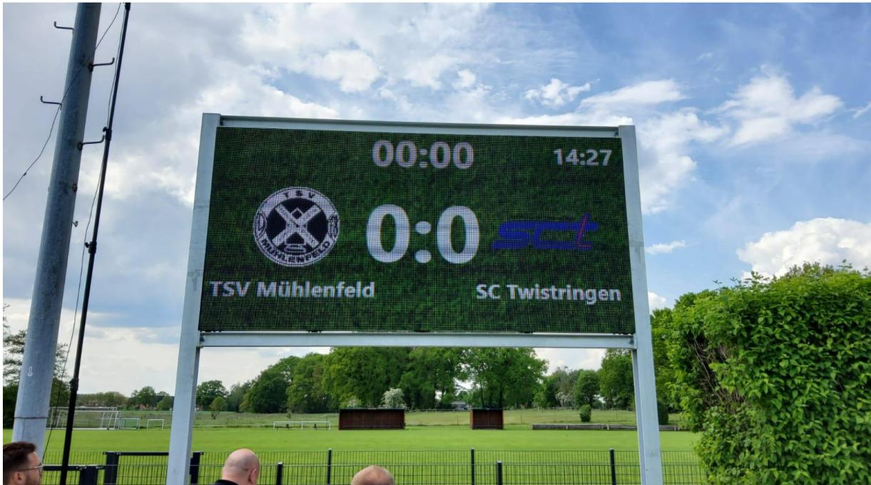
**LED Anzeigetafel** 3,84 x 1,92 - 10mm Pixel Displayfläche (BxH): 3,84 x 1,92 m Anzahl Module: 8
